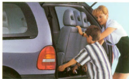
Modellen met het Easy Out Roller™ systeem zijn in het midden en achterin uitgerust met zitbanken die met een hendel aan de achterkant in een handomdraai van de vloerverankering kunnen worden ontgrendeld. De bank staat dan op acht wieltjes en kan heel eenvoudig uit de auto worden gehaald.
