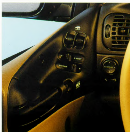
De elektrisch bedienbare ramen voorin (standaard op de SE met luxepakket, LE en LX) en de vergrendeling van de voorportieren en schuifdeuren zijn door middel van knoppen in het linkervoortuig centraal te bedienen vanaf de bestuurdersstoel.
