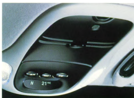
De dakconsole (standaard op de LE en LX) is uitgerust met boordcomputer, buitentemperatuurmeter, kompas en een opbergvak voor de zonnebril.
