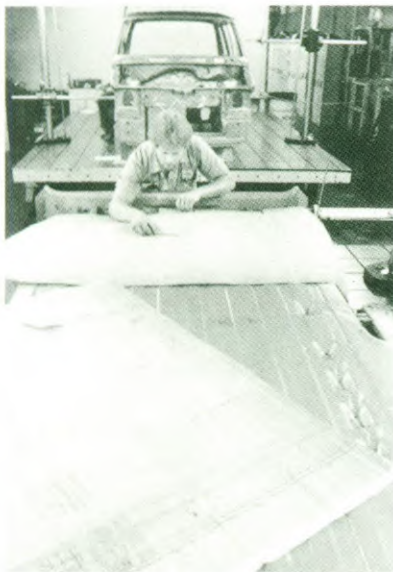
Een controleur vergelijkt de afmetingen van carrosseriedelen met het originele ontwerp
