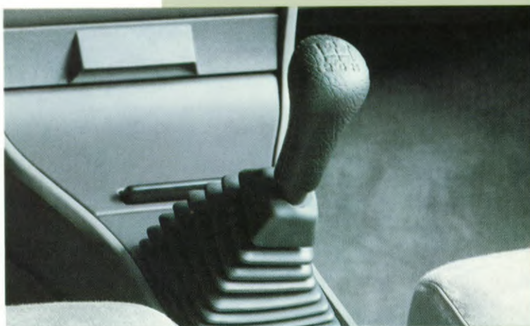
De Chrysler Saratoga 2.5i beschikt standaard over een vijfversnellingsbak, de 3.0i over een elektronisch geregelde 4-traps automaat.
