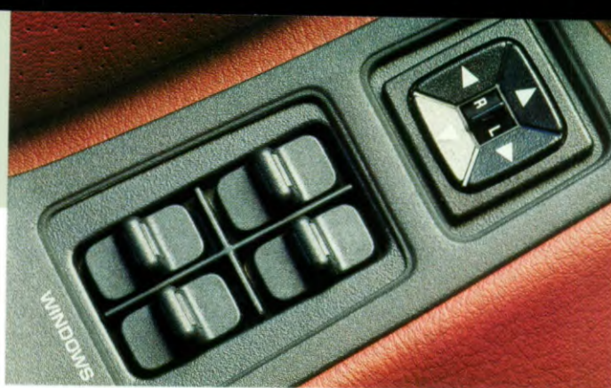
Elektrisch bedienbare zijruiten en elektrisch verstelbare en verwarmde buitenspiegels.
