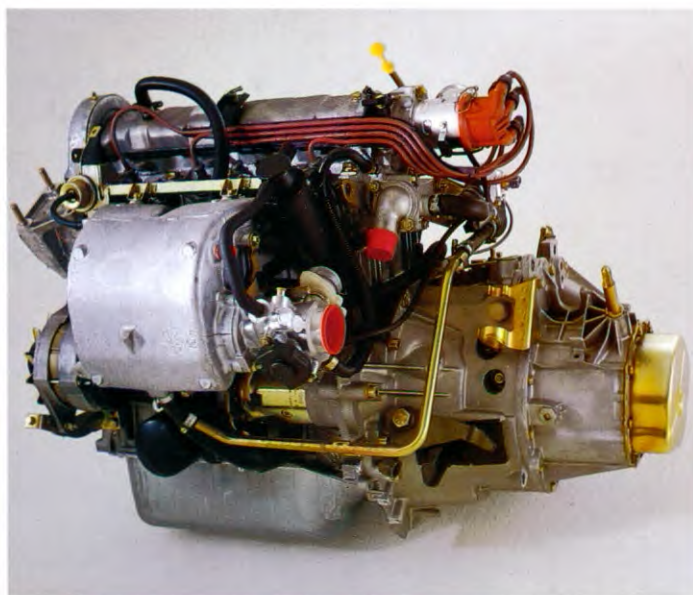
105 DIN pk benzine-injectiemotor
