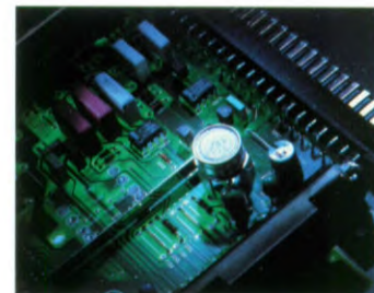
Intelligentes Motormanagement durch die Digitale Motor Elektronik (DME) und die Digitale Diesel Elektronik (DDE).
