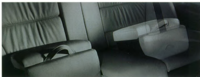
Zwei integrierte Kindersitze mit variabler Handhabung bieten Sicherheit für Kinder von eineinhalb bis vier bzw. über vier Jahren.
