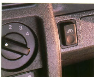
Een aparte schakelaar voor het anti-diefstal alarm, óók bruikbaar met geopend dak.
