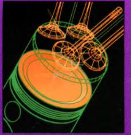
Die Konturen überlegener Sporttriebwerke: Die Gestaltung von Kolben und Brennräumen dokumentiert die hochleistungsorientierte Auslegung der M Power Triebwerke. 4-Ventil-Technik, kompakte, dachförmige Brennräume und muldenförmige Kolbenböden sind die High-Tech-Prämissen höchster Leistungsausbeute bei ökonomischer Kraftstoffausnutzung.
