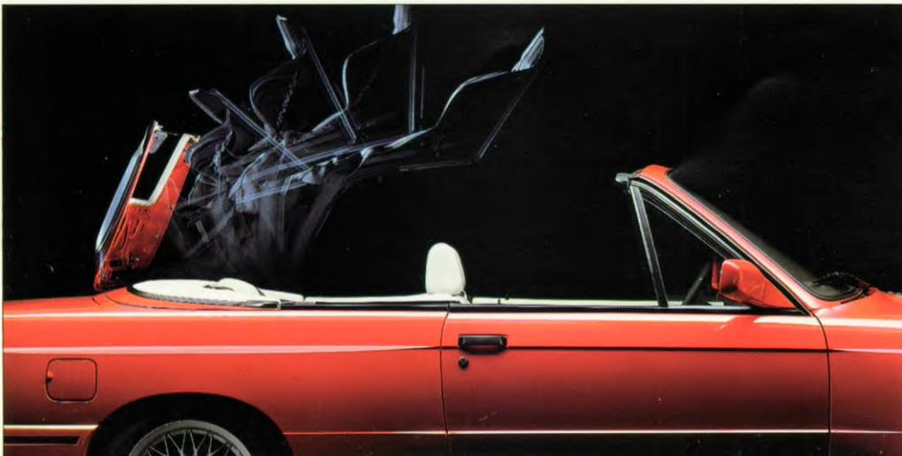
**Einerseits M3, andererseits Cabrio: Die Seitenfenster werden versenkt — selbstverständlich elektrisch. Zwei Spannhebel werden gelöst und nun vollzieht sich auf Knopfdruck eine präzise Zeremonie: Rasch und fast lautlos übernimmt es die elektro-hydraulische Verdeckautomatik, den M3 zum vollkommenen offenen Erlebnis zu machen.**
