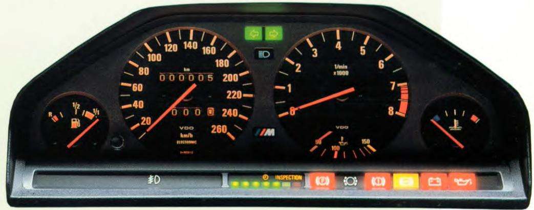
Die Prägnanz des M3 Cockpits: Primäre Funktionsanzeigen, z.B. für Geschwindigkeit und Motordrehzahl, sind optimal im Sichtfeld des Fahrers plaziert. Ihre Zeiger informieren im M3 in der Farbe mit der höchsten Signalwirkung: Rot.
