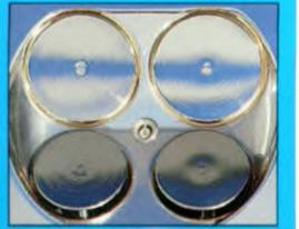
Der M5-Sechszylinder realisiert weltweit die höchste spezifische Leistung aller 4-Ventil-Saugmotoren mit Katalysator. Die Überlegenheit hat Ursachen: Extrem kompakte Brennräume des neuen M5-Triebwerks erlauben z. B. eine hohe Verdichtung knapp unter der Klopfgrenze. Resultat: optimale, emissionsarme Verbrennung durch kurze, effektive Flammfronten.
