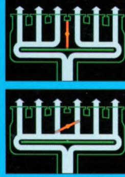
Copyright by BMW Motorsport GmbH: Das Ansaugsystem mit Resonanzsteuerung sorgt für die fulminante Entwicklung von Literleistung und -drehmoment. Die Nutzung variabler Gassäulen erhöht das Drehmoment unter 4100/min und die Leistung über 6700/min.
