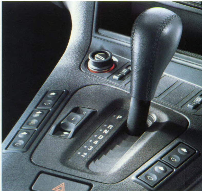
Wählen zwischen wirtschaftlicher und sportlicher Fahrweise: mit dem BMW 5-Gang-EH-Automatic-Getriebe.
