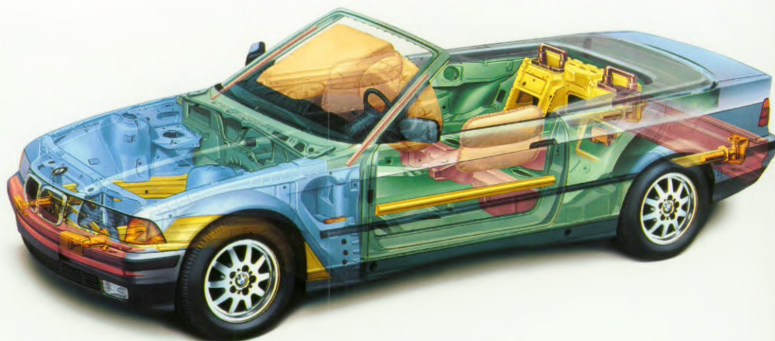
Zeichnet sich durch hohe Torsions- und Biegesteifigkeit aus: die Karosserie des BMW 3er Cabrio.
