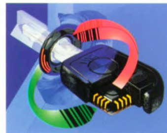
Die elektronische Wegfahrsperre (EWS): Eine doppelte elektronische Codierung im Schlüssel schützt vor unbefugtem Starten.
