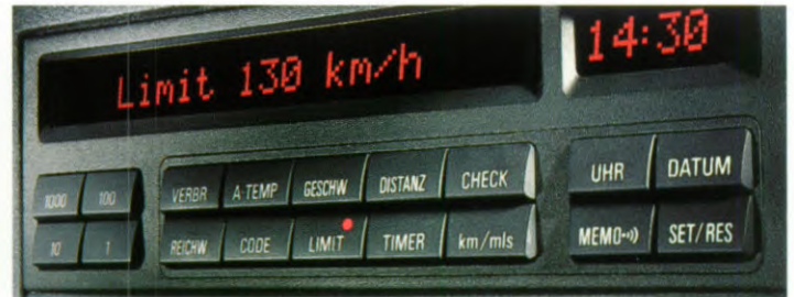
Das auf Wunsch erhältliche Multi Informations Display (MID) gibt dem Fahrer jederzeit Auskunft über den technischen Zustand des Fahrzeugs.
