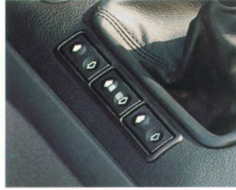
Fensterheber vorn und hinten elektrisch, mit Mautschaltung.
