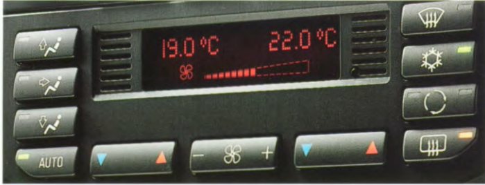
Die Klimaautomatik beinhaltet auch die Automatische Umluft Control (AUC).
