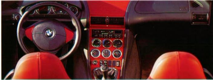
Markante Akzente setzen auch zusätzliche chromgerahmte Rundinstrumente auf dem Mitteltunnel. Sie informieren in analoger Form über Uhrzeit, Öltemperatur und Außentemperatur.
