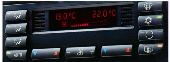
Per Tastendruck gewünschte Temperatur einstellen: Klimaautomatik inkl. Mikrofilter.
