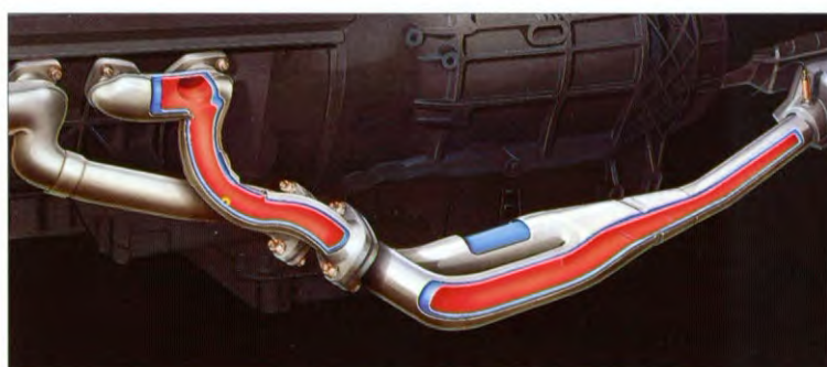
het aanslaan van de motor dat beide katalysatoren effectief zijn.
