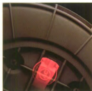
Speciale ribbels in het luchtfilter: één van de vele details die van een Rover 100 een echte Rover maken
