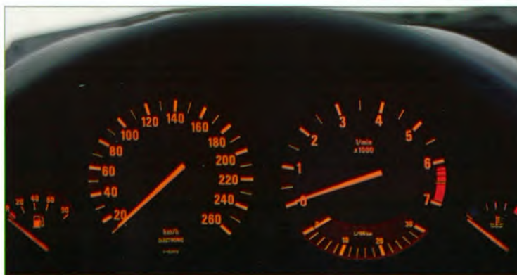
Analoge instrumenten in het directe gezichtsveld. Bij dag en nacht is voor alle belangrijke informatie één blik voldoende.
