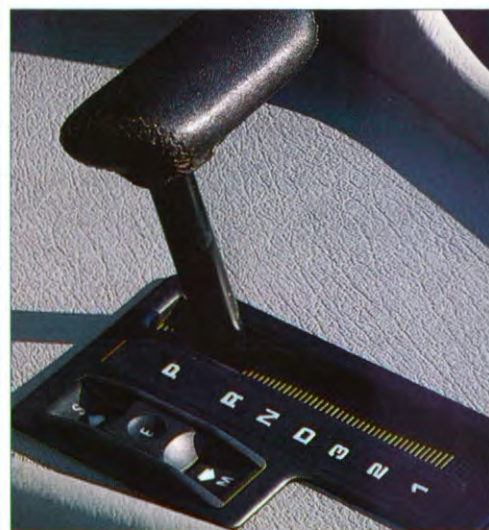
Als extra leverbaar: Automatische 4-versnellingsbak met elektronisch-hydraulische sturing (EH) en programmeerbaar: schakelaar: E = economy S = sport M = handbediening, om bij wegrijden op glad wegdek beter grip te verkrijgen
