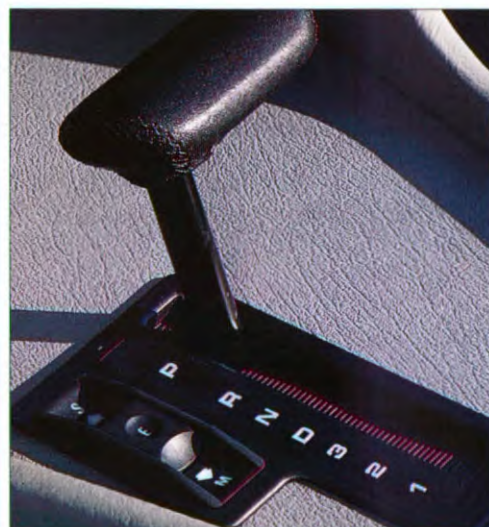
Als extra leverbaar: Automatische 4-versnellingsbak met elektronisch-hydraulische sturing (EH) en programmeerbare schakelaar: E = economy, S = sport, M = handbediening, om bij wegrijden op glad wegdek beter grip te verkrijgen.
