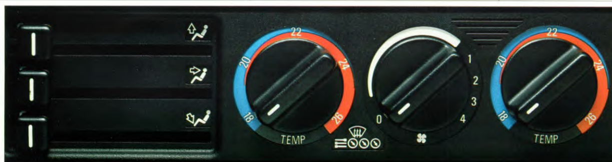
Elektronisch geregelde verwarming en luchtverversing. Voor bestuurder en passagier gescheiden regelbaar. Perfecte verdeling van de lucht. Krachtig, geruisarm en traploos regelbaar doet de radiaalventilator zijn werk.
