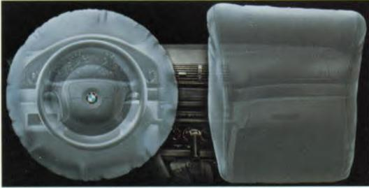
Insassenschutz durch Fahrer- und Beifahrer-Airbag. Der Beifahrer-Airbag hat eine Sitzbelegungserkennung.
