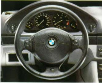
M Lederlenkrad mit Multifunktions-tasten und Airbag.
