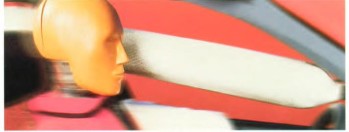
Der serienmäßige ITS-Kopf-Airbag bietet in Kombination mit dem Seitenairbag für Fahrer und Beifahrer einen bislang einzigartigen Seitenaufprallschutz.
