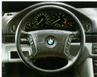
Lenksäule mit mechanischer Längs- und Höhenverstellung.
