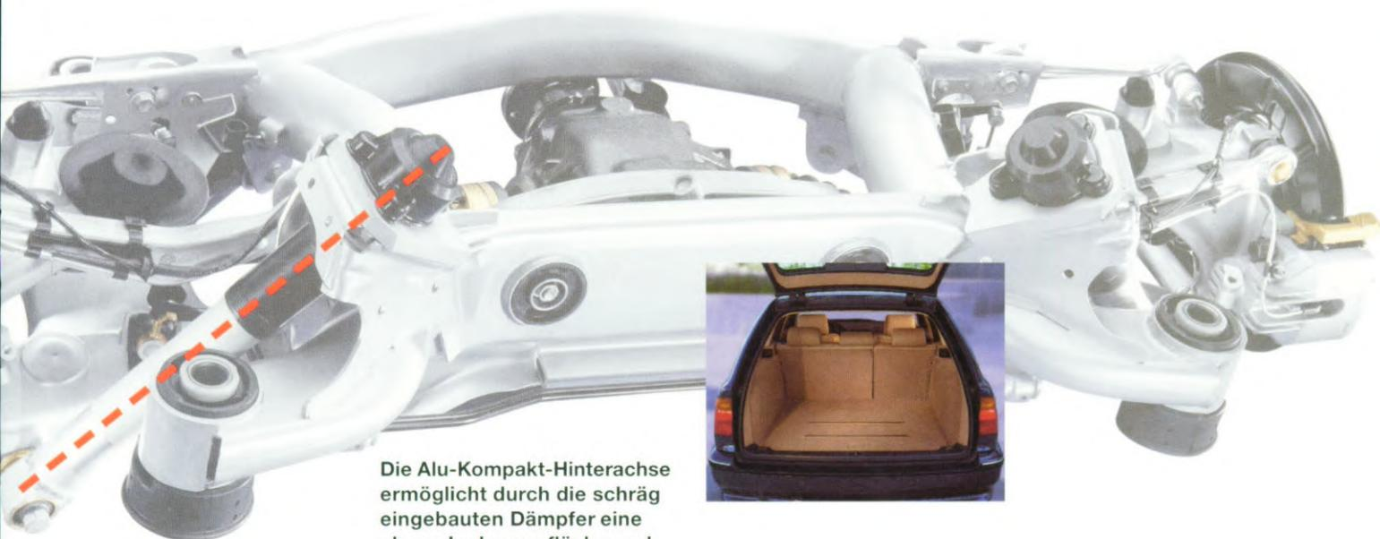
Die Alu-Kompakt-Hinterachse ermöglicht durch die schräg eingebauten Dämpfer eine ebene Laderaumfläche und parallele Seitenwände.
