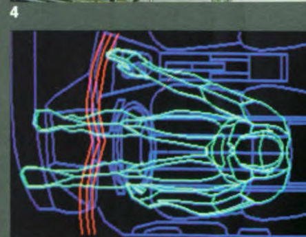
3 De ergonomische perfectie van de BMW cockpit is gebaseerd op intensieve research en proefnemingen. Op afbeelding 4 en 5 is het resultaat te zien van proefnemingen waarbij werd vastgesteld welke bedieningselementen op het dashboard binnen handbereik van de bestuurder liggen. De reikwijdtecontouren leveren een cirkel op, waarbinnen 95% van de bestuurders makkelijk bij de bedieningselementen kunnen.
