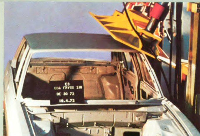
Beproeving van het dak.
