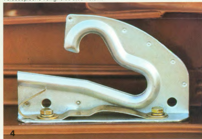
4 Speciale motorkapvergrendeling met vanghaken.
