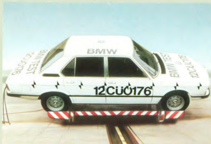
Zijdelingse koprol ter beproeving van de stabiliteit van de veiligheidsskool.
