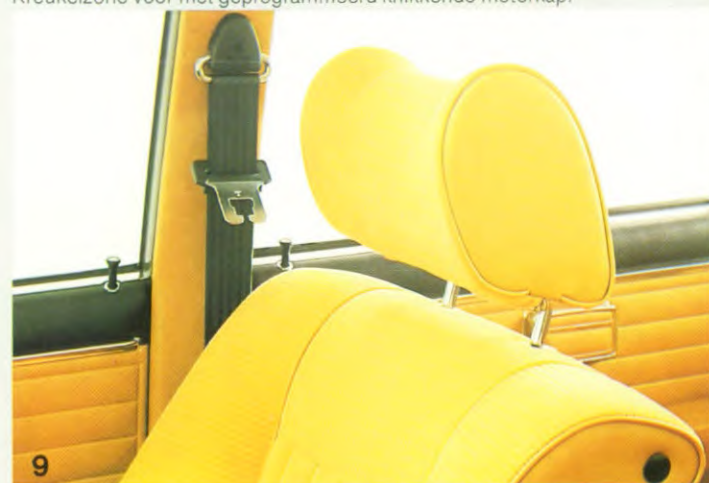
9 Combinatie van hoofdsteunen en driepunts automatische veiligheids-gordels vóór.
