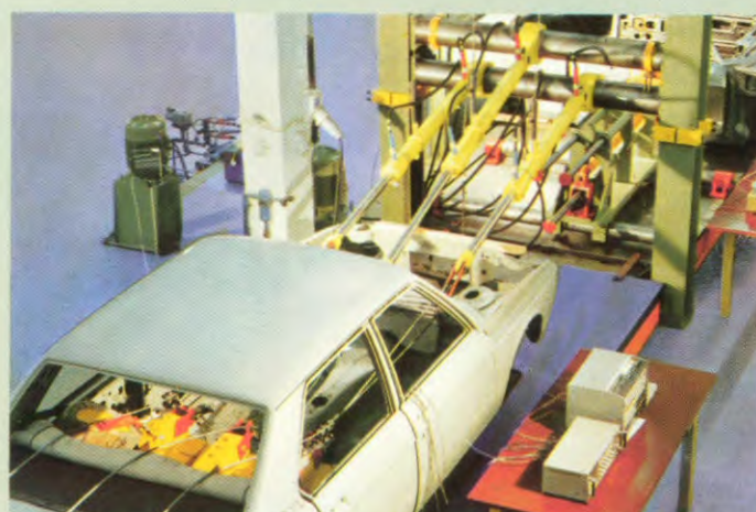
Beproeving van de bevestigingspunten van de veiligheidsgordels.
