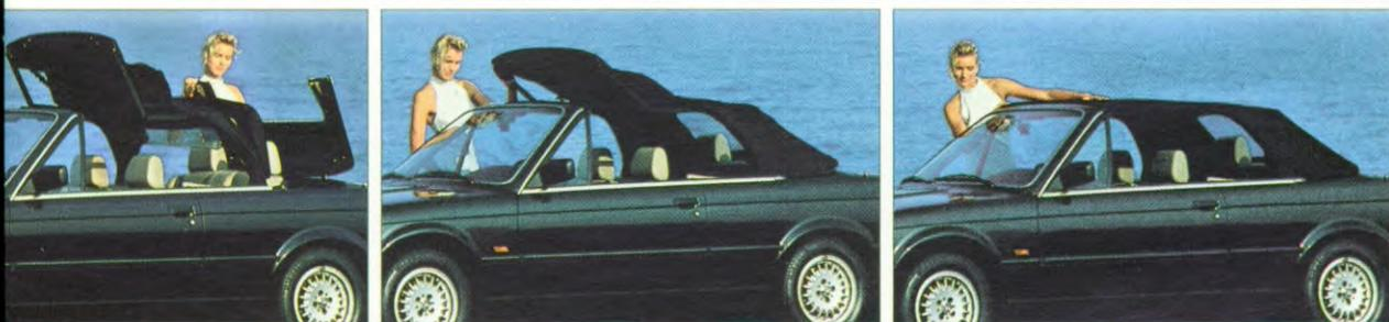
Das Öffnen und Schließen des Verdecks ist ein Kinderspiel. Durch die raffinierte Verdeckkinematik ist es mit wenigen Handgriffen in die versenkte Ablage gebracht. Kein lästiger „Rucksack“, der die Rücksicht behindert. Das Verdeck besteht aus strapazierfähiger Baumwolle mit eingewebten Gummifasern. Ein wetterfestes Cabriodach, das sich absolut dicht an die Karosserie anschmiegt.
