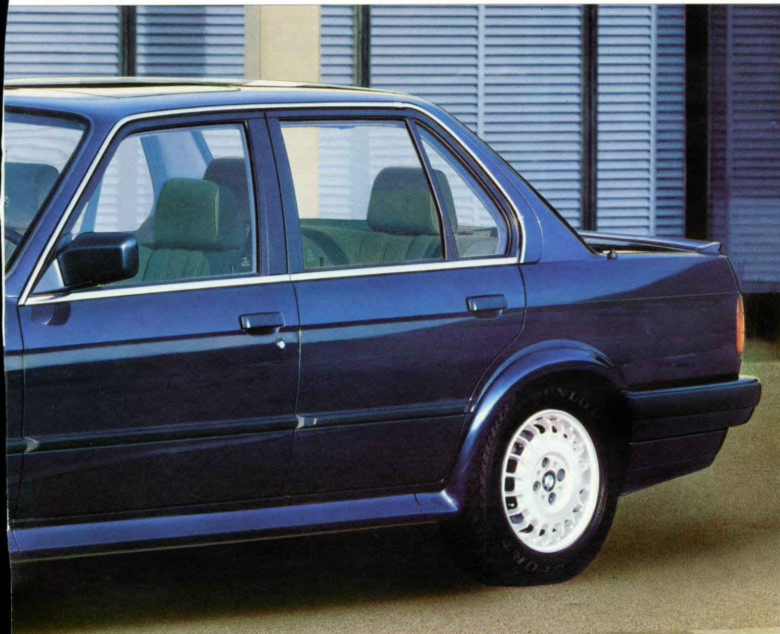
aus einem speziellen Kunststoff gefertigt. Sie überstehen jetzt Kollisionen mit bis zu 4 km/h ohne bleibende Verformung, und auch die
