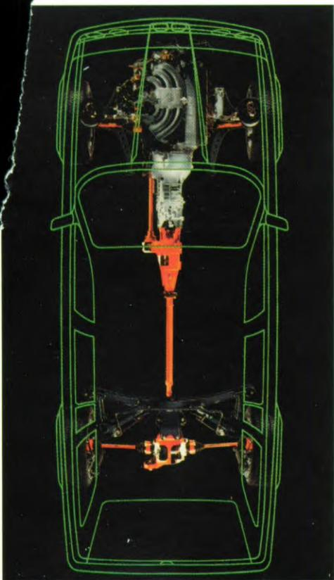
**Kraftverteilung.** Das BMW Allradsystem verteilt über ein zentrales Planetengetriebe die Antriebskraft im Verhältnis von 37% vorn zu 63% hinten auf die Antriebsachsen. Eine Viscosperre am Zentraldifferential greift bei Schlupf selbsthemmend ein,
