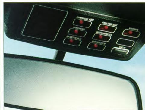
**Permanente Überprüfung.** Die serienmäßige Check-Control überwacht laufend Kühlmittel-, Motoröl-, Wasserstand und die wichtigsten Beleuchtungseinrichtungen. Fehlfunktionen werden so frühzeitig erkannt. Auch die Ölkontrolle beim Tanken entfällt (ab 320i).
