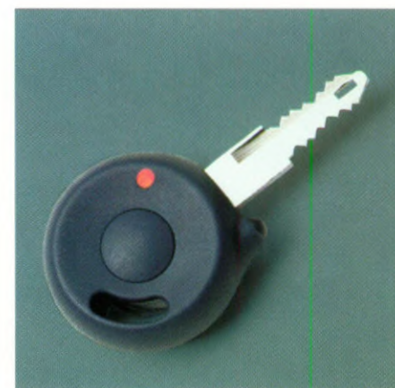
Centrale vergrendeling van portieren en achterklep met de in een sleutel ingebouwde afstandsbediening.
