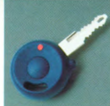
▲ Centrale vergrendeling van de portieren en achterklep met afstandsbediening geïntegreerd in de contactsleutel
