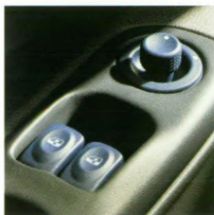
Elektrische ruitbediening en bediening van de buitenspiegels
