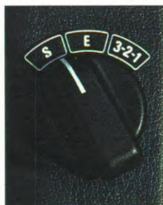
De 4-versnellingsautomaat met elektronisch/hydraulische (EH) regeling voor drie rijprogramma's.
