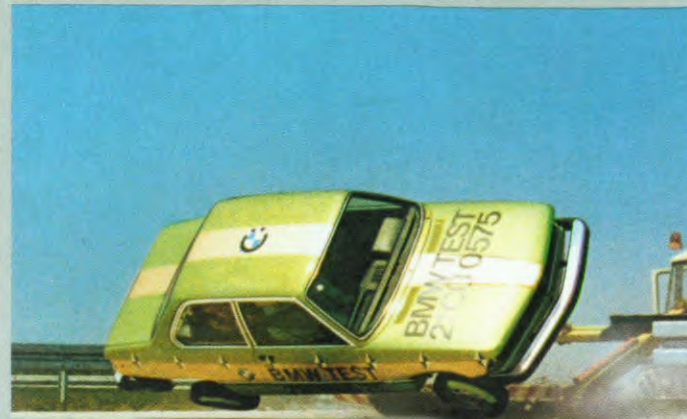
Zijdelingse koprol voor stabilisatieproef van de veiligheidskooi.
