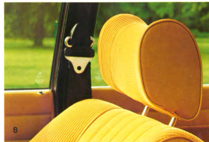
Veiligheidscombinatie-systeem van verstelbare hoofdsteunen en automatische veiligheidsgordels.
