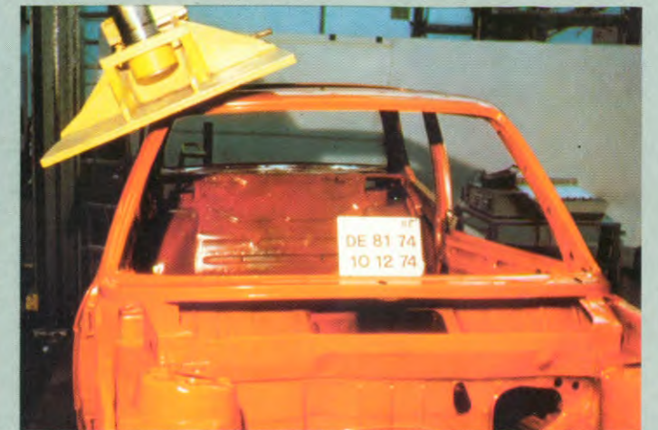
Beproeving van de dakstijlen en de ingebouwde rolbeugel.
