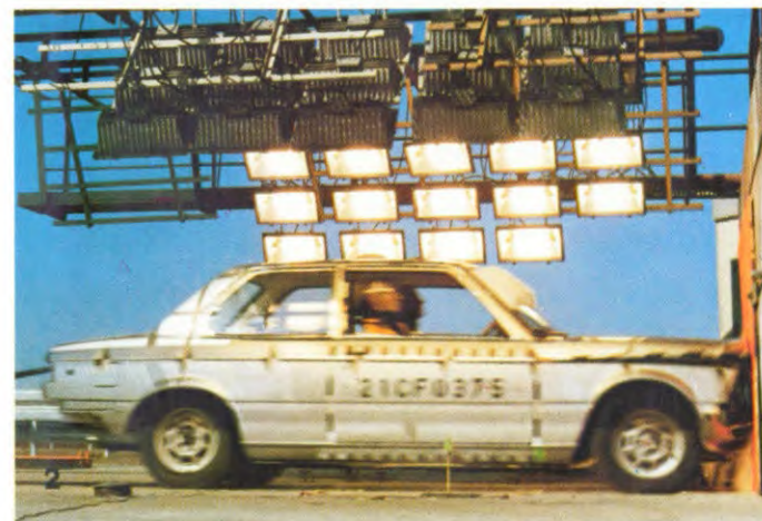
Crash-test ter beproeving van de kreukelzones voor en achter.
