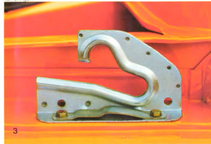
Speciale motorkap-vergrendeling met vanghaken.
