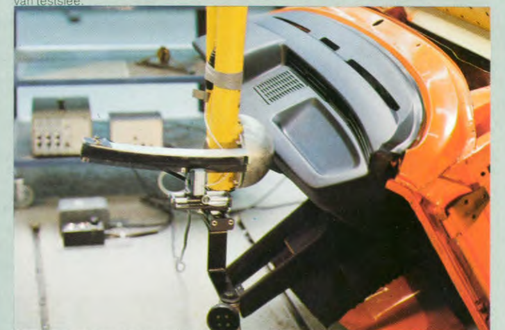
Botsingproef tegen het beklede, schokabsorberende dashboard.
