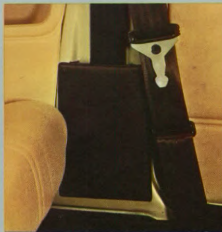
De veiligheidsgordels zijn in de portierstijlen weggewerkt.
