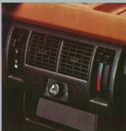
Bediening van verwarming en ventilatie.
