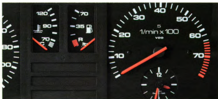
Toerenteller met ingebouwde analoog klok
