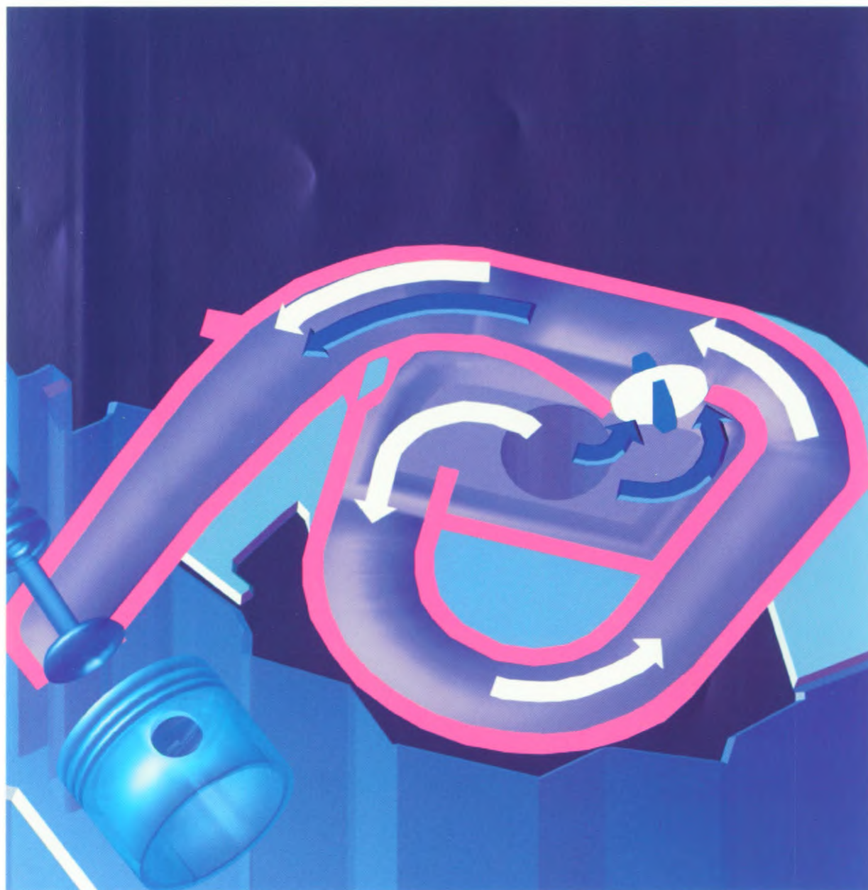
Variabel inlaatspruitstuk in de 2.8E: een lang inlaatkanaal voor een hoog koppel bij lage toerentallen (witte pijl). En een kort inlaatkanaal voor een hoog vermogen vanaf 4100 1/min (blauwe pijl).
