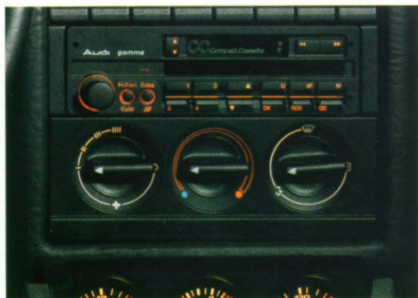
Die Bedienungselemente für Heizung und Belüftung.
