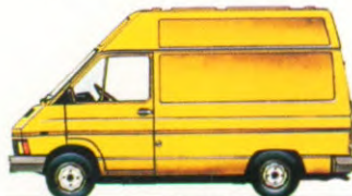
GESLOTEN BESTELWAGEN-KORT- VERHOOGD DAK. DIESEL 2068 CM 3 . ± 1000 KG LAADVERMOGEN.
