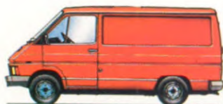
GESLOTEN BESTELWAGEN-KORT-NORMAAL DAK. BENZINE 1647 CM 3 . ± 1000 KG LAADVERMOGEN.
