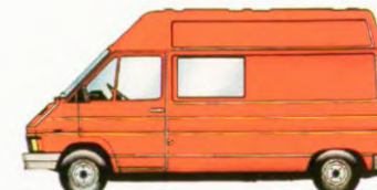
GEMENGDE BESTELWAGEN-LANG-VERHOOGD DAK. BENZINE 1397 CM 3 , 1115 KG LAADVERMOGEN.
