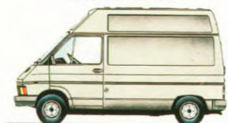
GESLOTEN BESTELWAGEN-KORT-VERHOOGD DAK. BENZINE 1397 CM 3 , 940 KG LAADVERMOGEN.
