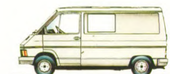
GEMENGDE BESTELWAGEN-KORT-NORMAAL DAK. BENZINE 1397 CM 3 , 940 KG LAADVERMOGEN.
