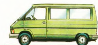
BESTELWAGEN MET ZIJRUITEN-KORT-NORMAAL DAK. BENZINE 1397 CM 3 , 940 KG LAADVERMOGEN.
