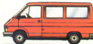
MICROCAR-KORT-NORMAAL DAK. DIESEL 2068 CM 3 . 9 PLAATSEN.
