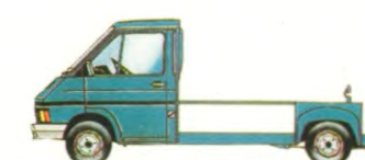
PLATFORM-CABINE-LANG BENZINE 1397 CM 3 . LAADVERMOGEN AFHANKELIJK VAN OPBOUW.
