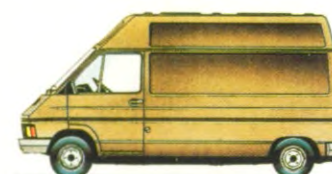
GESLOTEN BESTELWAGEN-LANG-VERHOOGD DAK. BENZINE 1397 CM 3 , 1115 KG LAADVERMOGEN.
