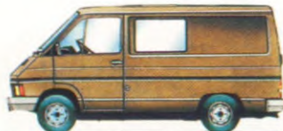
GEMENGDE BESTELWAGEN-KORT-NORMAAL DAK. BENZINE 1647 CM 3 . ± 1000 KG LAADVERMOGEN.
