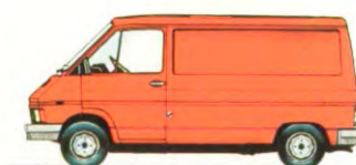
GESLOTEN BESTELWAGEN-KORT-NORMAAL DAK. DIESEL 2068 CM 3 , 960 LAADVERMOGEN.
