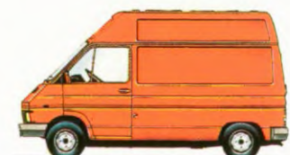
GESLOTEN BESTELWAGEN-KORT-VERHOOGD DAK. DIESEL 2068 CM 3 , 940 KG LAADVERMOGEN.
