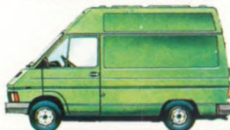
GESLOTEN BESTELWAGEN-KORT- VERHOOGD DAK. BENZINE 1647 CM 3 . ± 1000 KG LAADVERMOGEN.
