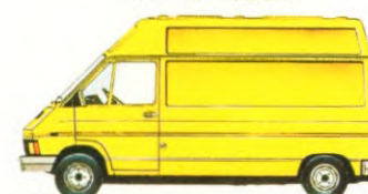
GESLOTEN BESTELWAGEN-KORT-VERHOOGD DAK. DIESEL 2068 CM 3 , 1115 KG LAADVERMOGEN.
