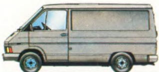
GESLOTEN BESTELWAGEN-KORT-NORMAAL DAK. DIESEL 2068 CM 3 . ± 1000 KG LAADVERMOGEN.
