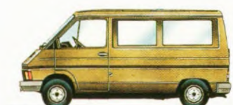
BESTELWAGEN MET ZIJRUITEN-LANG-VERHOOGD DAK. DIESEL 2068 CM 3 , 940 KG LAADVERMOGEN.
