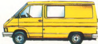
GEMENGDE BESTELWAGEN-KORT-NORMAAL DAK. DIESEL 2068 CM 3 . ± 1000 KG LAADVERMOGEN.
