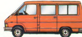
TOERISME-KORT-NORMAAL DAK. DIESEL 2445 CM 3 . 8 PLAATSEN.
