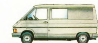
GEMENGDE BESTELWAGEN-KORT-NORMAAL DAK. DIESEL 2068 CM 3 , 940 KG LAADVERMOGEN.
