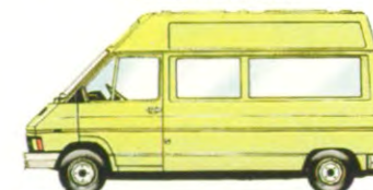
BESTELWAGEN MET ZIJRUITEN-LANG-VERHOOGD DAK. DIESEL 2068 CM 3 , 1115 KG LAAD-VERMOGEN.
