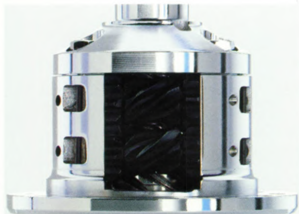
Het Torsen tussendifferentieel regelt de aandrijfverdeling automatisch en variabel.
