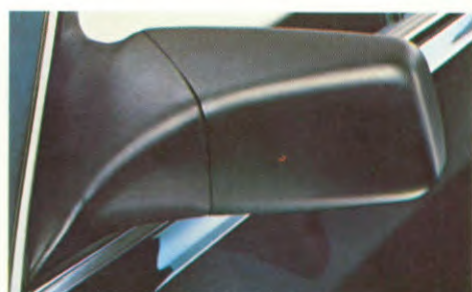
Ook de aërodynamisch gevormde buitenspiegel draagt z'n steentje bij aan de gunstige C_W -waarde.
