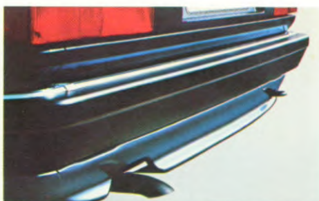
Onder de achterbumper bevindt zich een tweede luchtgeleider.
