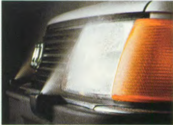
Wis-was-installatie op de koplampen (standaard bij CD).
