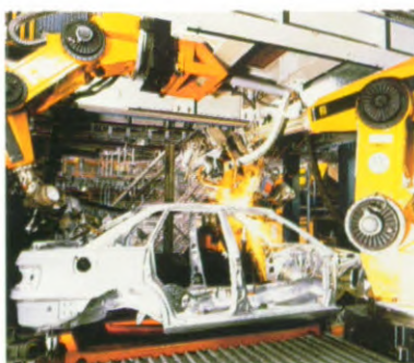
robots lassen het dak
