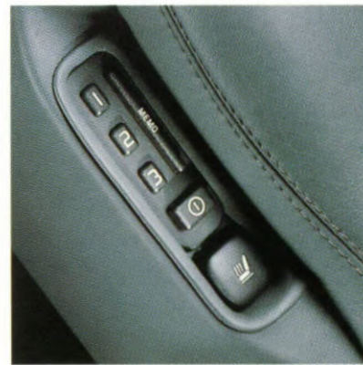
Bedieningsknoppen Memory-systeem voor positie bestuurdersstoel.
