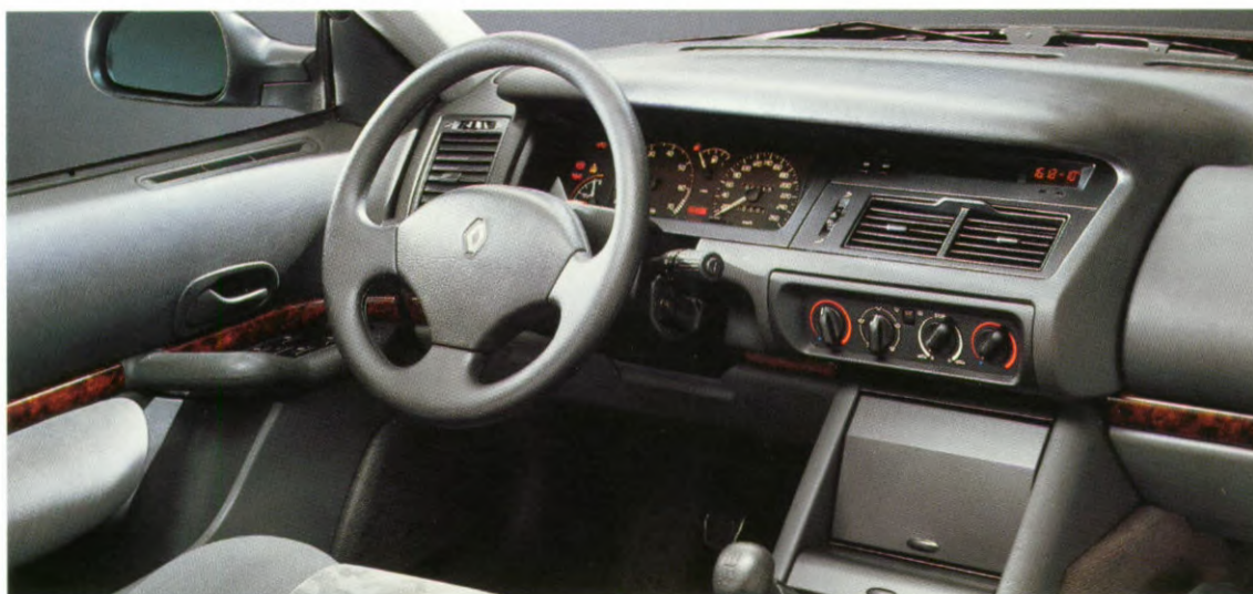
Het complete dashboard van de Safrane Manoir. Elektrisch verstelbare spiegels en buitentemperatuurmeter zijn onderdeel van het extra comfortpakket.
