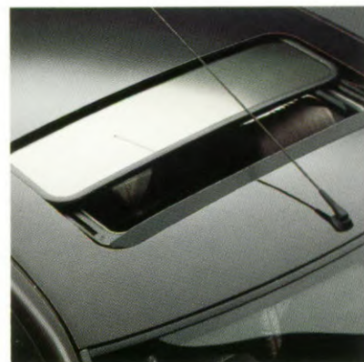
Elektrisch bedienbaar glazen schuif-/kanteldak met wegschuifbare hemelbekleding.
