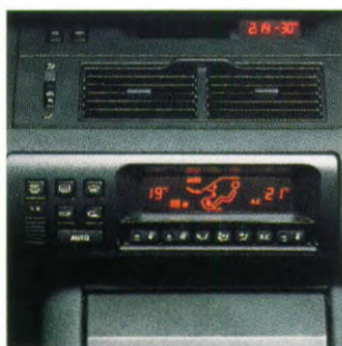
Elektronisch geregelde airconditioning.
