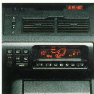
Elektronisch geregelde airconditioning.
