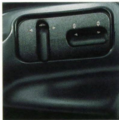
Bedieningsknoppen van de elektrisch verstelbare voorstoelen.
