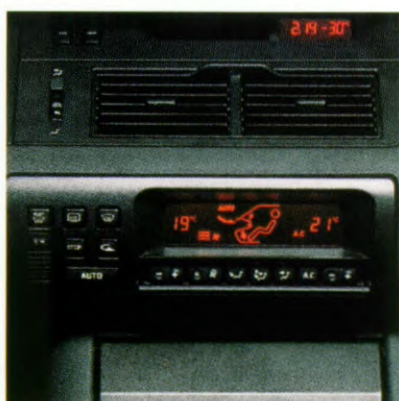
Elektronisch geregelde airconditioning.
