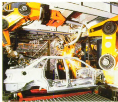
robots lassen het dak
