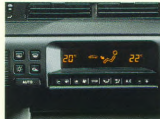
Door de « zonnescijjn »-toets houdt de airconditioning automatisch rekening met extra zonnige omstandigheden.
