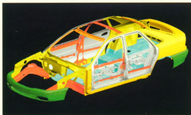
Versterkte carrossierestructuur met progressieve kreukelzones die de botsingskrachten absorberen.
