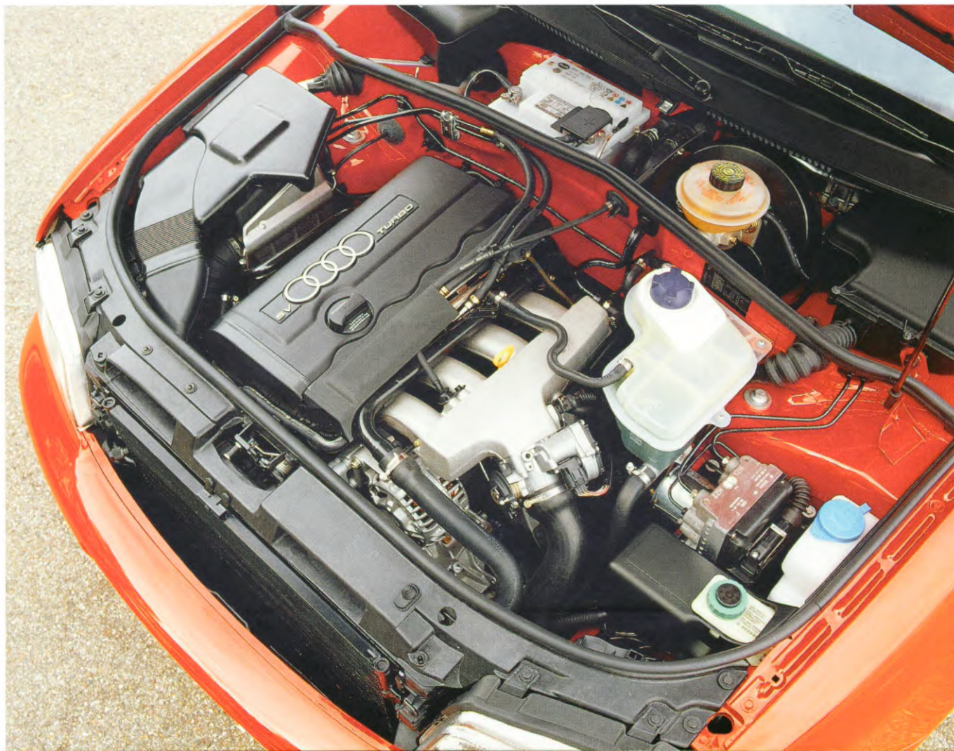
Audi 1,8 Liter-Vierzylinder-Fünfventil-Turbomotor 110 kW bei 5.700 min -1 210 Nm von 1.750 min -1 bis 4.600 min -1
