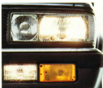
Halogeen koplampen (aparte unit grootlicht) en in de bumper geïntegreerde mistlampen
