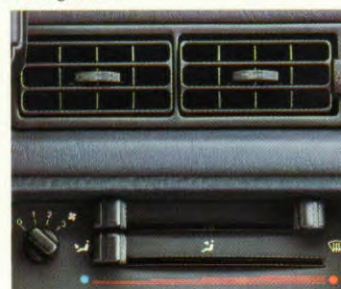
Verwarmings- en ventilatiesysteem met 3-traps ventilator
