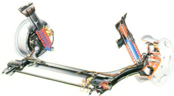
De nieuwe achterasconstructie van de Audi 80.
