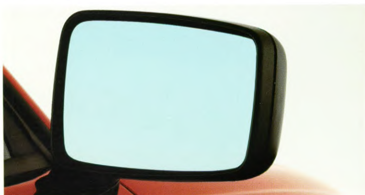
Electrisch verwarmbare en van binnenuit verstelbare buitenspiegels
