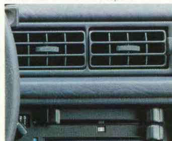
Verwarmings- en frisseluchtinstallatie met drietrapsventilator
