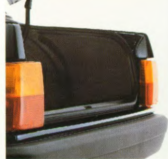
Kofferklep met twee gasgevulde veren en ver naar onderen doorlopend
