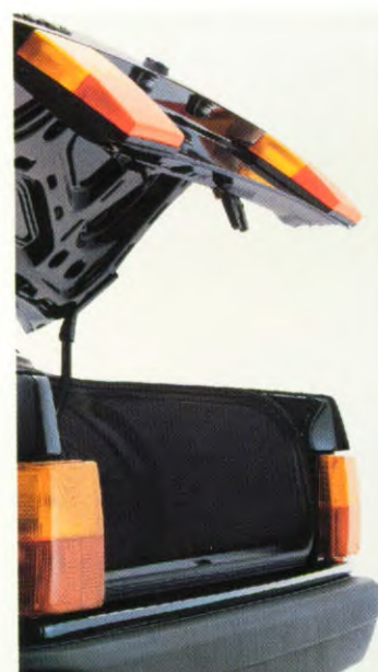
Kofferklep met twee gasgevulde veren en ver naar onderen doorlopend
