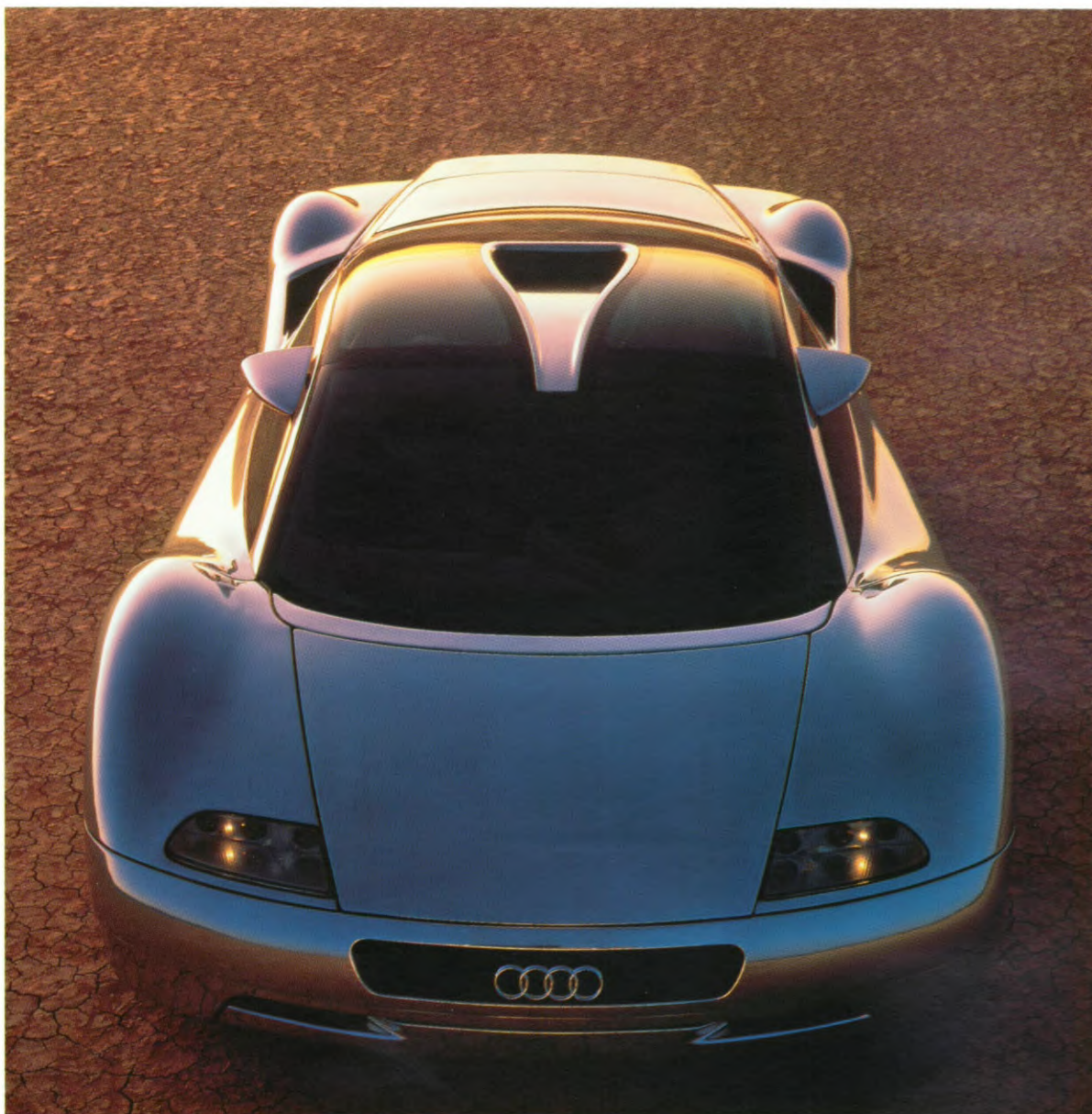
AVUS quattro, studie-model uit 1991 met volledige aluminium carrosserie, twaalfcilindermotor in w-vorm, 60 kleppen, motorinhoud 6 liter, topsnelheid ca. 340 km/u, 374 kW (509 pk) bij 5.800 toeren per minuut.
