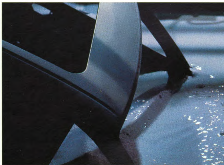
De volledig verzinkte carrosserieën krijgen hun grondlak in een kataforese-dompelbad.
