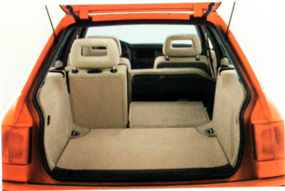
De achterbank en de rugleuning van de Audi Avant voor tweederde naar voren geklapt.
