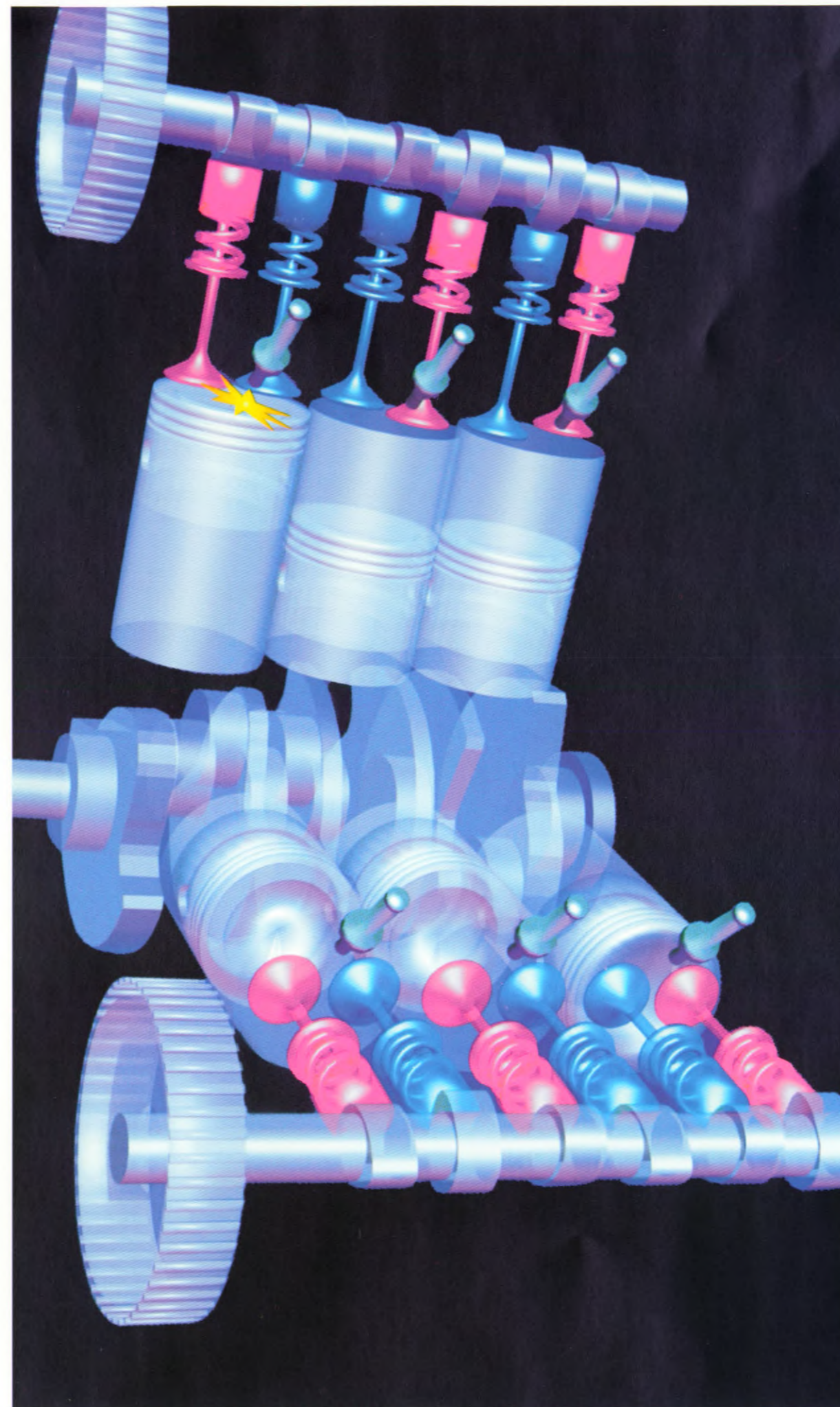
Extreem korte bouw wijze van de motor d.m.v. "split-pin" krukastap (één krukastap met 30°-kromming voor twee drijfstangen) en geringe hoogte d.m.v. 90°-V-constructie.
