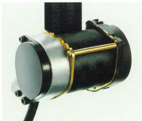
Gordelautomaat met geïntegreerde kabeltrommel voor aanspannen van de gordel.
