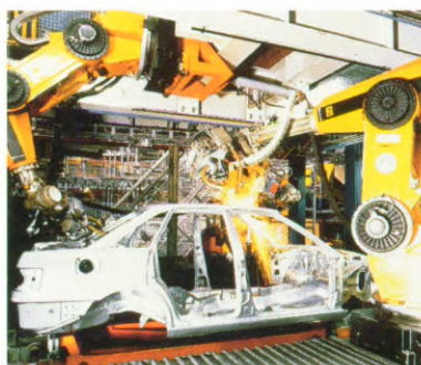
Robots lassen het dak
