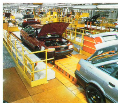
Montagestation met platform
