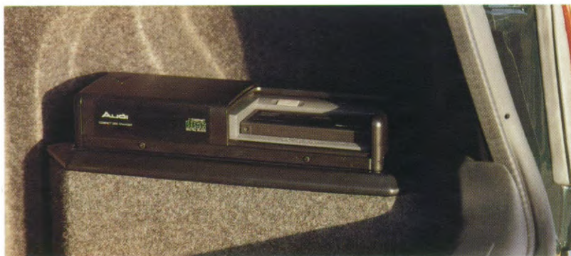
De CD-wisselaar van de Audi gamma CD (meeruitvoering) wordt in de bagageruimte ondergebracht.
